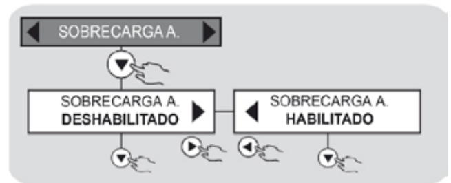
ALARMA de SOBRECARGA
